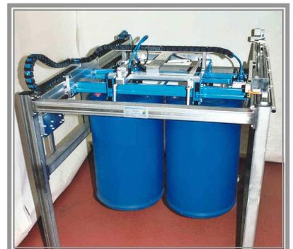
Bild 4: Automatischer 2-fach Fassübersetzer für Europaletten
