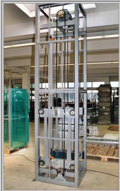
Bild 3: Vertikalförderer Typ SF 90 K in der Montagehalle bei SAW
