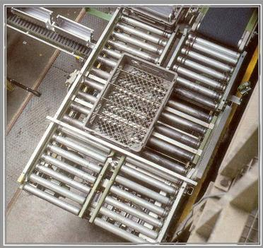
Bild 5: Hubquertransfer für Körbe
