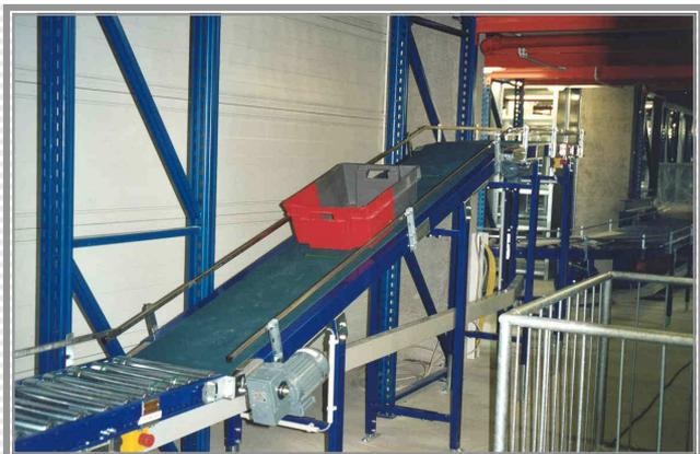
Bild 3: Steigband mit Grippgurt und Übergabeband
