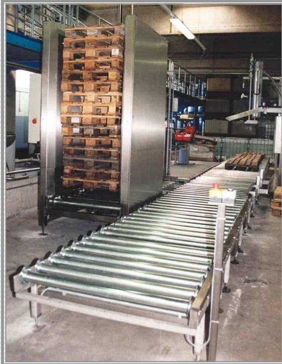
Bild 1: Palettenspender in VA mit Palettenrollenbahn
