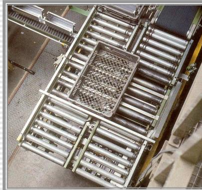
**WIN-Line Pusher** sind pneumatisch ausgeführt und arbeiten wie die Schwenkabweiser über der eigentlichen Förderebene. Ausnahme ist jedoch der Pusher mit versenkbaren Mitnehmern. Eingebaut im Röllenförderer ziehen zwei Mitnehmer das Fördergut zur Seite heraus. Auf dem Rückweg werden die Mitnehmer pneumatisch nach Unten abgesenkt. So kann auch dicht aufeinander kommendes Fördergut ausge schleust werden.
