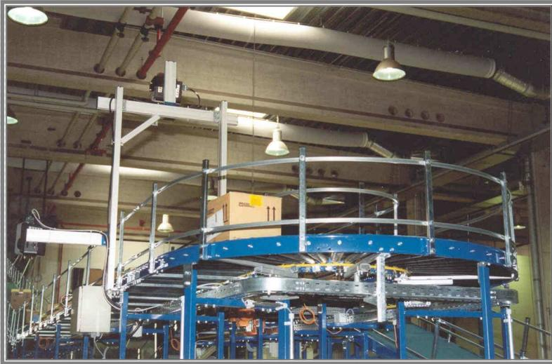
Bild 1: Der Duplex Scanner zum Sortieren der gepackten Kartons für die jeweiligen Länder.
