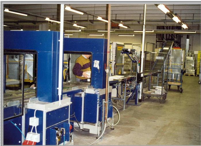
Bild 3: 2x Umreifen u. Abtransport im UG zum Versand
