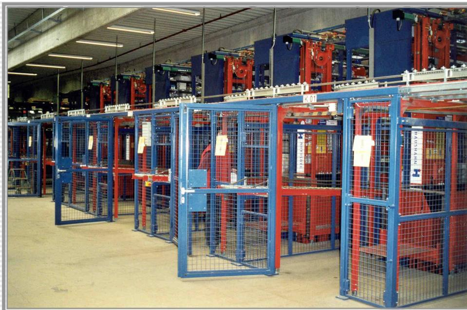
Bild 4: Die Bereitstellung der Teile aus dem Hochregallager mit Regalbediengeräten auf die FlexLine Rollenbahnen
