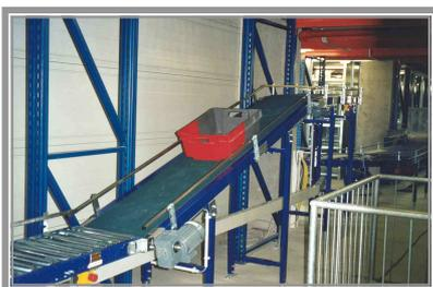
Bild 7: Steigbandförderer mit Auslauf
