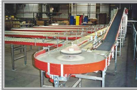
Bild 3: Der Drehtisch im Lagerbereich
