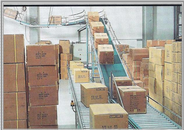
Bild 2: Gefälleband mit Auslaufband und Grippgurt
