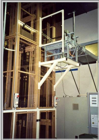
Bild 2: Vertikalförderer Typ SF 90 K mit Übergabe- und Auslaufrollenbahn bei Continental Teves
