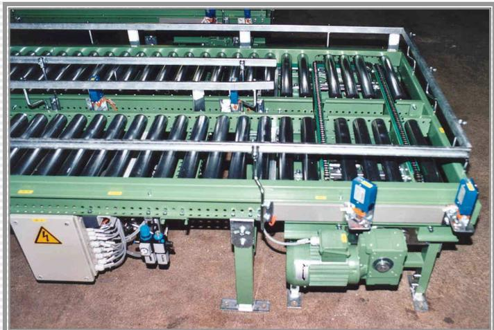
Bild 2: Hubtransfereinheiten mit Rollenbahnen
