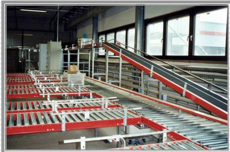
Bild 2: Die Kommissionierung der Großbestellungen im Lagerbereich mit 7 Bahnhöfen.
