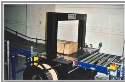
Bild 5: Der vollautomatische Umreifer
