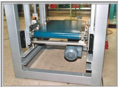
Bild 4: Vertikalförderer Typ SF 90 K mit Gurtband Typ 50
