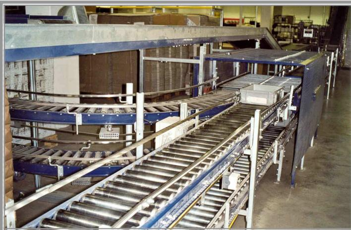
Bild 2: Verteilen der Behälter u. Abtransport in UG zum Versand
