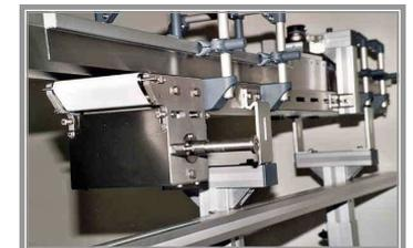
Bild 8: 90° Mini-VA-Messerkantenband
