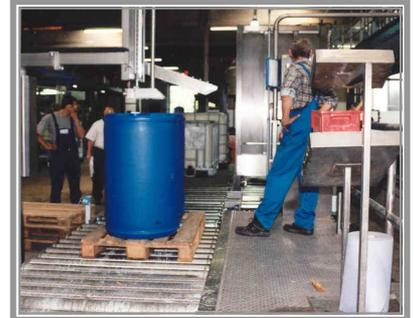
Bild 3: 2-fach Fasstransport auf der Europalette an der Abfüllstation
