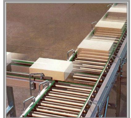
**Unsere Kettentransfereinheiten** sind gekennzeichnet durch die solide Konstruktion und sind dadurch so variabel, daß sie den unterschiedlichen Rollenabständen und Nennbreiten der Rollenförderer immer angepaßt werden können. Eine VA-Kette (3/8x7/32) mit geraden Laschen, kleinen Umlenkungen, geschlossenem Kettenrücklauf und ein geschickt angeordneter Schneckengetriebemotor garantieren hohe Funktionalität bei kleinstmöglicher Einbauhöhe.
