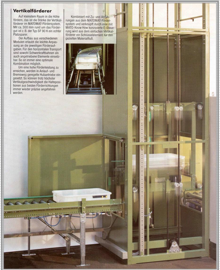
Bild 1: Vertikalförderer Typ SF 90 K im Einsatz
